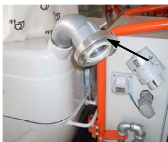
Рис. 14: Подсоединить шланг для транспортировки
